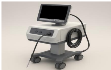
Рис. 1. Аппарат Раман-спектроскопии с эндоскопической системой
