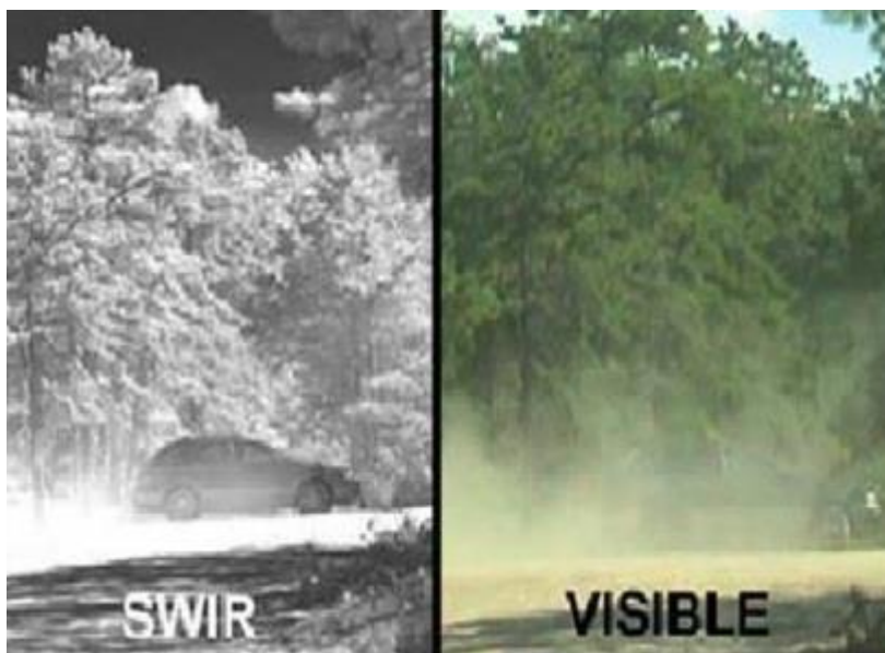
Рис. 1. Съемка SWIR-камерой (слева) и обычной камерой (справа). Источник фото: Фомин Ф.В. Современное состояние и перспективы развития зарубежных ИК-систем. Аналитический обзор. – М.: ЗАО «МНИТИ», 2018
