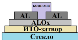
Рис. 1. Структура экспериментального полевого транзистора
