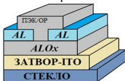
Рис. 1. Структура экспериментального полевого транзистора
