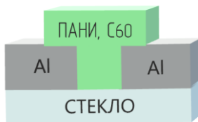
Рис. 1. Структурная схема резистивного датчика
